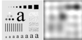
半径为10的理想低通滤波结果，它滤除掉13%的总功率。结果如此模糊，说明大部分图像尖锐细节在这13%的功率之内。
